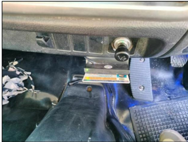
รูปที่ 2-22 การติดตั้งระบบ Global Positioning System (GPS)
